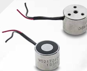
La massima forza, indicata in Kg, si intende a traferro zero; pertanto la superficie dell'elettropermanente e del pezzo metallico da attrarre sono a diretto contatto tra loro. La superficie del pezzo metallico è lavorata con la minima rugosità. Lo spessore è di 10 mm.
