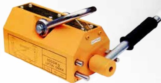
I sollevatori a comando manuale sono adatti a sollevare barre, tondi, lamiere, stampi, putrelle o altri pezzi di ferro. Essendo costruiti con magneti permanenti, rappresentano il massimo nella sicurezza del sollevamento, in quanto non staccano il pezzo se non dopo l'azionamento della leva. Hanno il vantaggio di poter spostare i pezzi in modo celere ed evitando imbracature con funi o catene.
