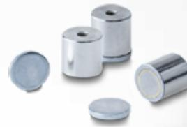
I Sistemi magnetici permanenti in alnico sono indicati, in special modo, per essere utilizzati ove la temperatura raggiunga valori superiori ai 100°C, fino a 600/650 °C. Sono anche consigliati ove sia necessaria lavorare le superfici di contatto, in quanto sono gli unici sistemi magnetici che si possono lavorare ad utensile.
