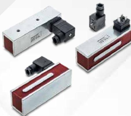
La massima forza, indicata in kg, si intende a traferro zero; cioè con la superficie dell'elettromagnete e del pezzo metallico da attrarre a diretto contatto. La superficie del pezzo metallico è lavorata con la minima rugosità. Lo spessore è di 10 mm. A parità di spessore e rugosità si ottengono forze magnetiche decrescenti con Ferro Fe 35, Acciaio 60, Ghisa malleabile, Ghisa grigia e Acciaio rapido.
