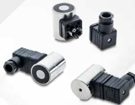
La massima forza, indicata in kg, si intende a traferro zero; cioè con la superficie dell'elettromagnete e del pezzo metallico da attrarre a diretto contatto. La superficie del pezzo metallico è lavorata con la minima rugosità. Lo spessore è di 10 mm. A parità di spessore e rugosità si ottengono forze magnetiche decrescenti con Ferro Fe 35, Acciaio 60, Ghisa malleabile, Ghisa grigia e Acciaio rapido.
