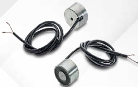
La massima forza, indicata in kg, si intende a traferro zero; cioè con la superficie dell'elettromagnete e del pezzo metallico da attrarre a diretto contatto. La superficie del pezzo metallico è lavorata con la minima rugosità. Lo spessore è di 10 mm. A parità di spessore e rugosità si ottengono forze magnetiche decrescenti con Ferro Fe 35, Acciaio 60, Ghisa malleabile, Ghisa grigia e Acciaio rapido.
