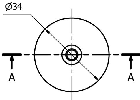
Fissaggio con viti M4 testa svasata a norma DIN 965 - ISO 7046
